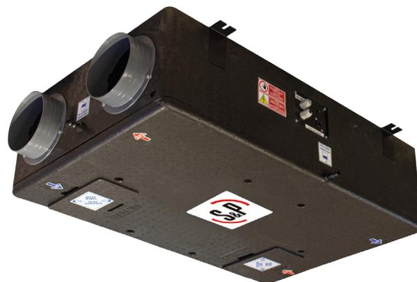
VMC a doppio flusso per abitazioni, con scambiatore di calore in controcorrente che garantisce un'efficienza fino all'85% assicurando un continuo rinnovo dell'aria.
