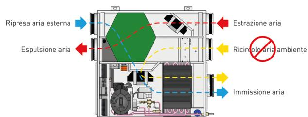
La gamma delle unità BR-DH di Soler&Palau è in grado di deumidificare senza l'attivazione del ricircolo dell'aria ambiente. Mantenendo la sola portata di rinnovo, ed evitando di ricircolare l'aria ambiente, le unità sono in grado di garantire una capacità di deumidificazione compresa tra il 96% ed il 94% rispetto alla configurazione standard. Questo grazie a specifiche scelte progettuali nella selezione e dimensionamento dei componenti, tra cui lo scambiatore con proprietà entalpiche.
